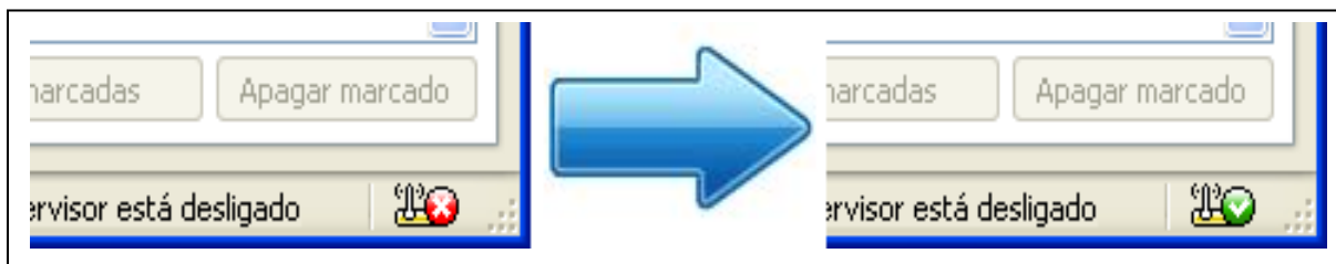
Figura 4.4.5: Após a configuração bem sucedida do sistema o sinal de status do modem muda da cor vermelha (modem não conectado) para verde (modem conectado).
